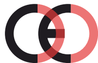
Marcatura CE contraffatta (troppo vicino)
